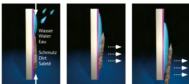
Wassertropfen setzen sich auf die HT-veredelte Fliese und verbinden sich zu einem homogenen Wasserfilm, dieser läuft gleichmäßig ab und spült so alle Schmutzpartikel von der Fliese herunter.
